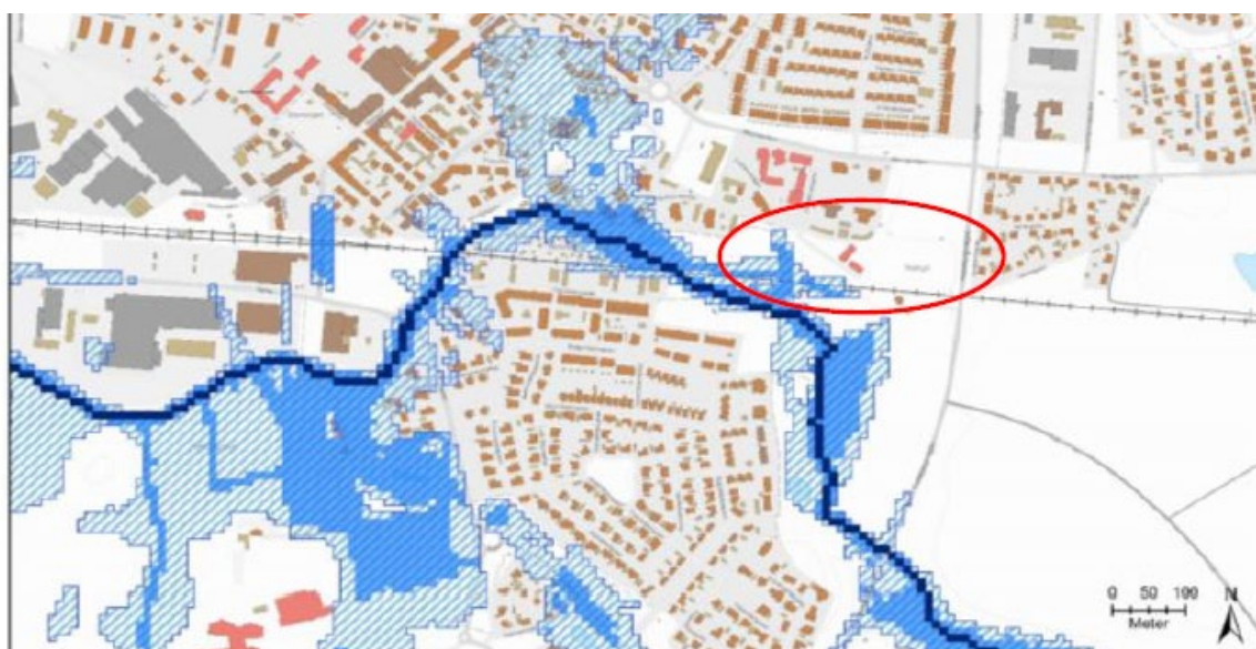
Länsstyrelsens svämplansanalys för Sege å med höjning av vattenytan om 1,5 respektive 2,5 meter.
