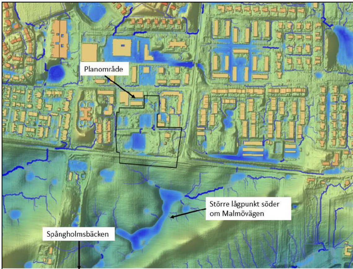
Figur 15. Översvämnings- och större flödesvägar vid skyfall. Dagvattnet från planområdet ansamlas i första hand inom planområdet och avrinner därefter till en lågpunkt på åkern söder om planområdet (Scalco Live, 2021).
