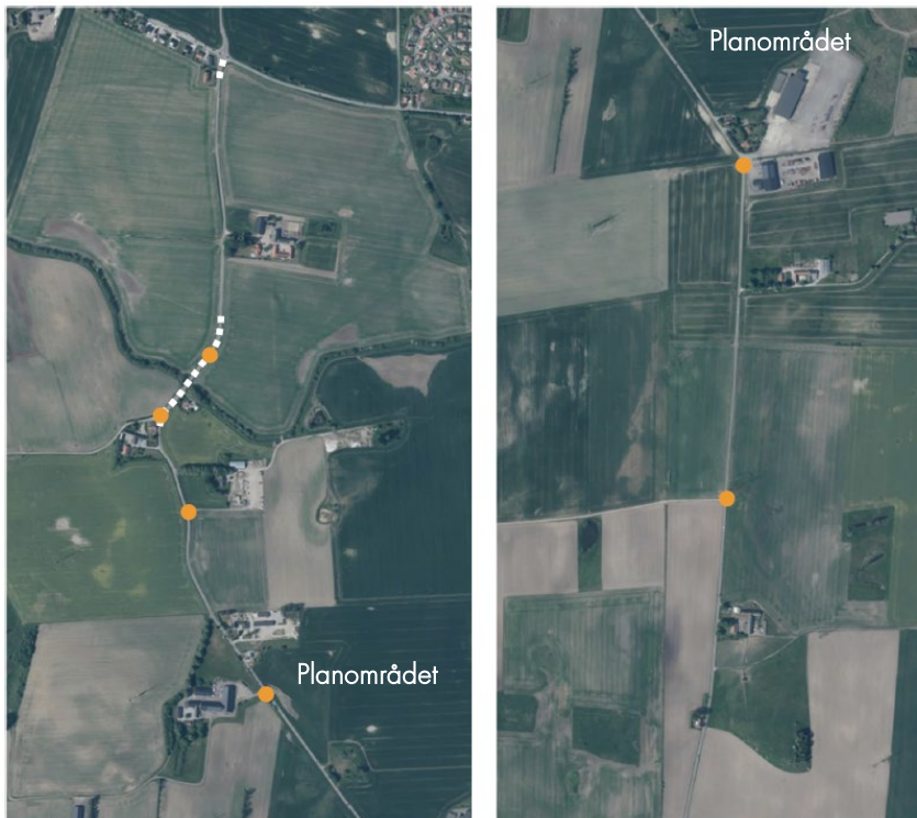
Platser utmed Tjustorpsvägen med möjlighet för två tunga fordon att mötas, samt sträckor med bredd >5,5 meter (Trafikutredningen, Tyréns, 2026-02-12)
