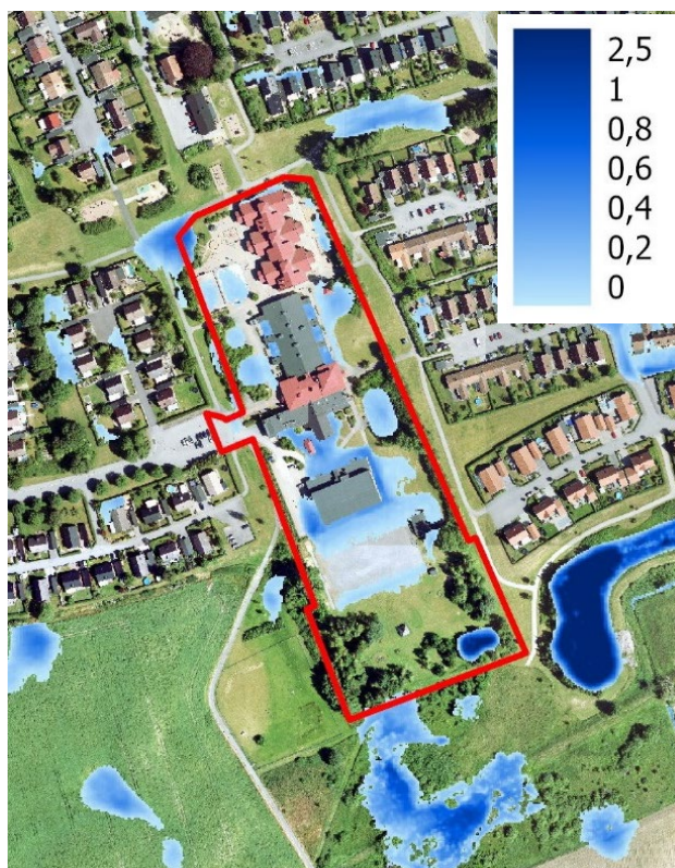
Figur 12. Stående vatten vid skyfall, djup i meter. Simulering och grafik: Sweco.
