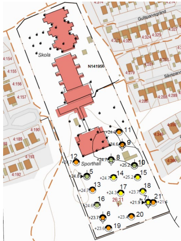
Figur 6. Prover vid markmiljöutredningen. Grönt uppår MRR – mindre än ringa risk, gult MKM – mindre känslig markanvändning och orange IFA – icke farligt avfall. Gult och orange behöver saneras. Ritning av Miljöfirman Konsult Sverige.
