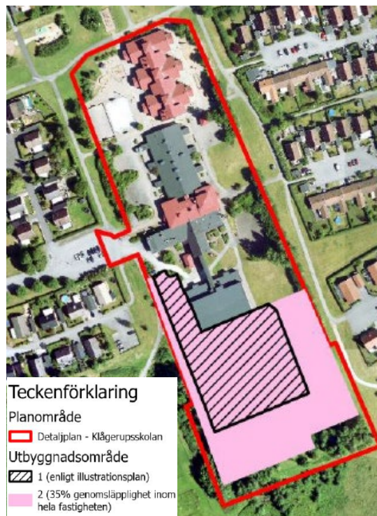
Figur 7. Utbyggnadsområden för beräkning enligt illustrationsplan (utbyggnadsområde 1) och beräkning enligt 35% genomsläpplighet enligt plankarta (utbyggnadsområde 2) för Klågerupskolan.
