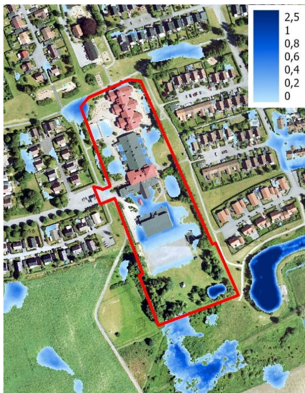
Figur 27. Stående vatten vid 100-årsregn med klimaffaktor 1,25, djup i meter. Simulering och grafik: Sweco.
