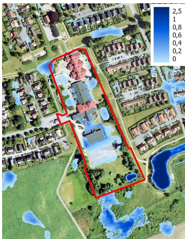
Figur 27. Stående vatten vid 100-årsregn med klimataffaktor 1,25, djup i meter. Simulering och grafik: Sweco.
