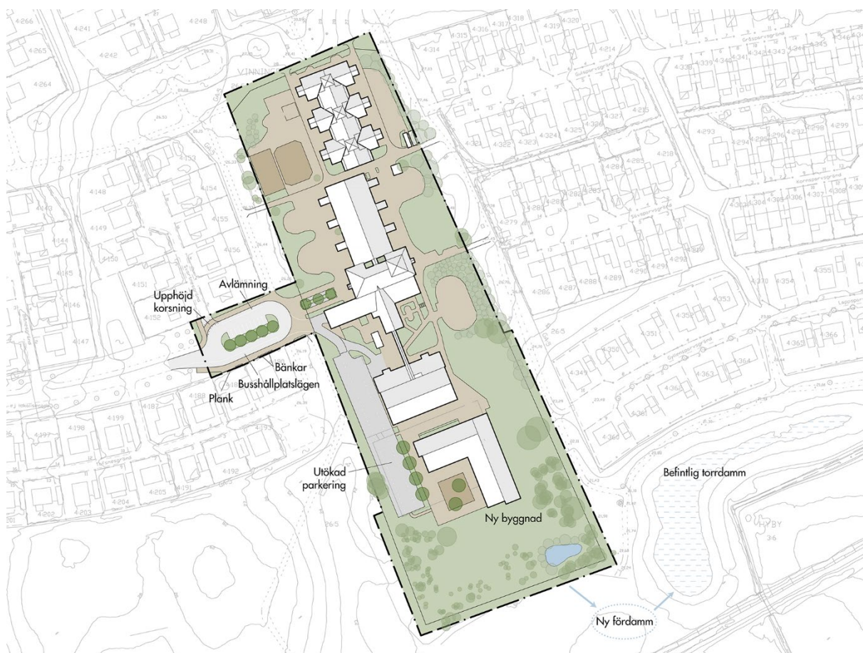
Figur 3. Illustrationsplan av en möjlig gestaltning av Klågerupskolans utbyggnad utifrån detaljplanens regleringar. Tillkommande dagvattenhantering sker i en ny fördamm vid sydöstra hörnet av planområdet. Illustration: Svedala kommun.
